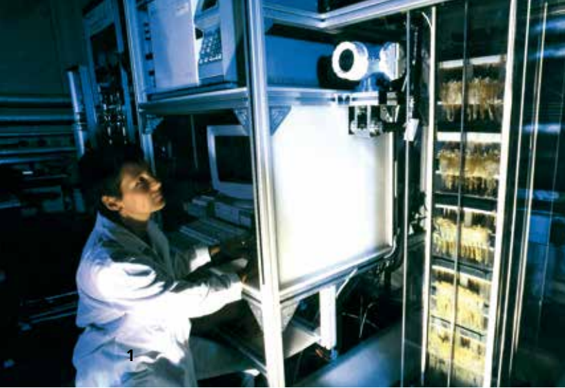
1 Grundwasserreinigung im Rieselbettreaktor
