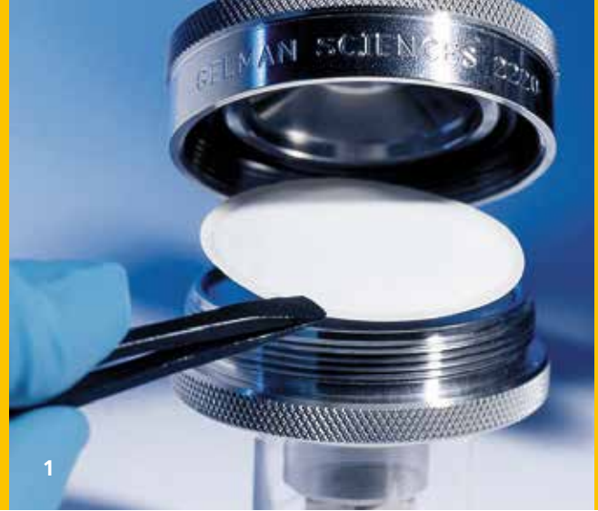
1 Kompositmembran mit geprägten Nanopartikeln für selektive Trennprozesse
